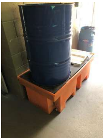
Figura 36 – Palete de contenção para produtos químicos
