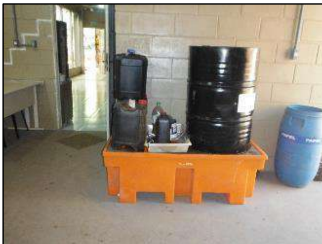
Figura 10 - Armazenamento de óleo lubrificante e resíduos perigosos em pallet contentor.
