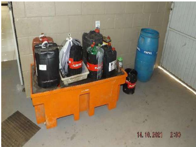
Foto 10: Acondicionamento de resíduos perigosos em pallet de contenção.
